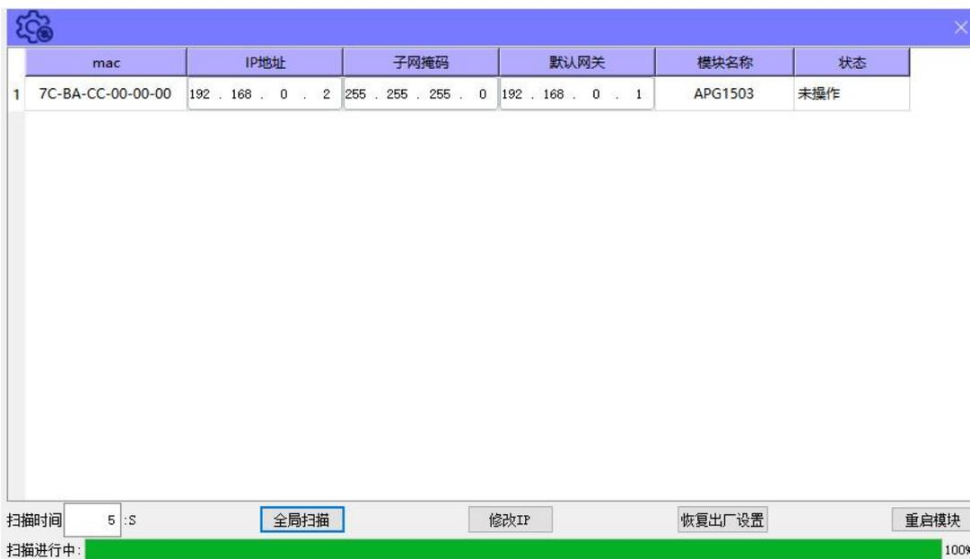
在表格中修改 IP 地址，完成修改后，点击“修改 IP”将修改的 IP 下载到模块里面，看后面的状态栏显示分配成功即可。
