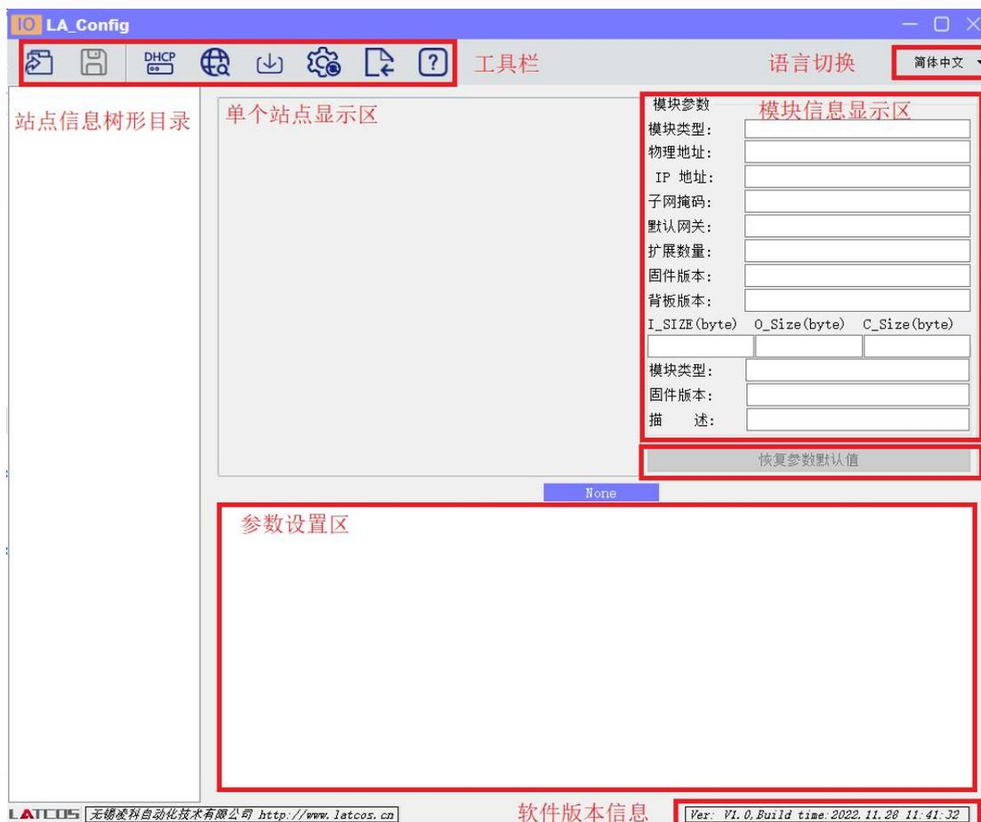
本软件界面包含了：工具栏，模块信息树形目录，参数设定区，模块信息显示区等等。
